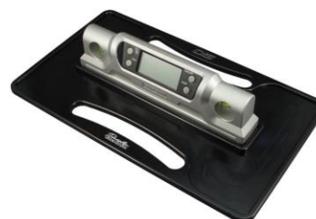
Figure 6 : Appareil de mesure officiel pour contrôler l'inclinaison des selles
