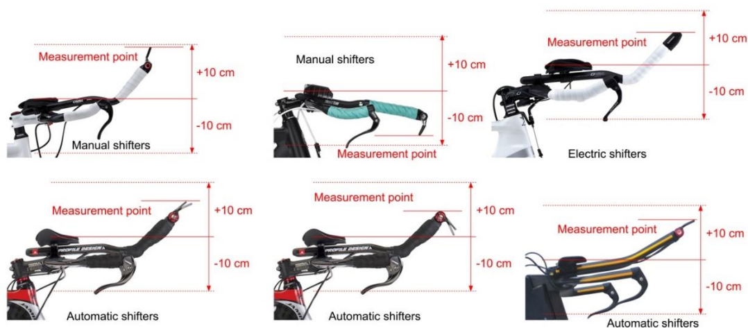
Figure 46 : Points de mesure pour les limites verticales de l'extension fixe additionnelle du guidon de contre-la-montre avec tous ses accessoires
