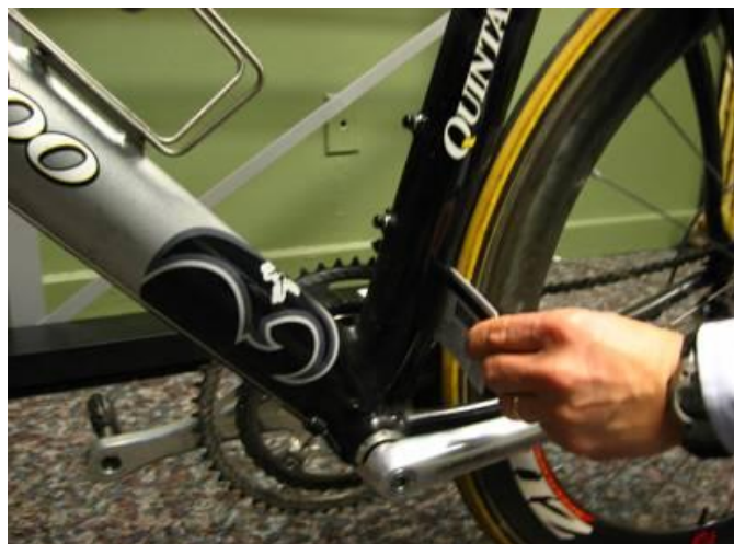
Figure 57 : Insertion d'une carte rigide entre la roue et le cadre afin de vérifier l'absence de carénage
